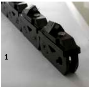
1 - CATENA DI TIPO "POSITIVO" LARGHEZZA DEL TAGLIO 40 / 42 mm
